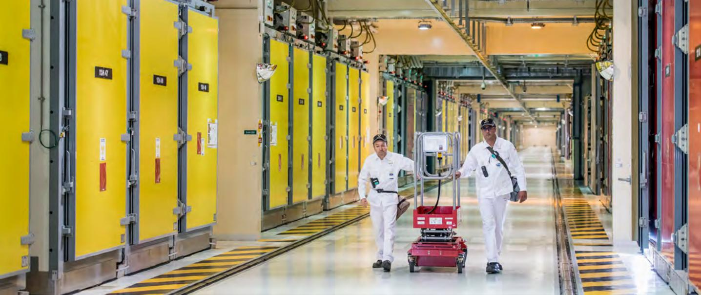
Opérateurs dans un hall station de l'usine Georges Besse 2. Stations portes rouges où l'on récupère les cylindres remplis d'uranium enrichi ; stations avec portes jaunes où l'on récupère les cylindres contenant de l'uranium appauvri.
